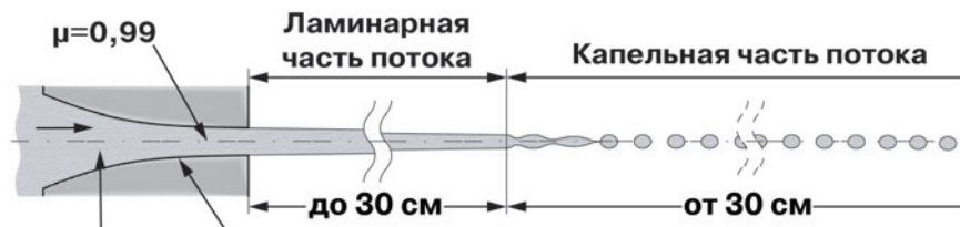
Рис. 7. Поведение потока воды при прохождении через коноидальное отверстие.
